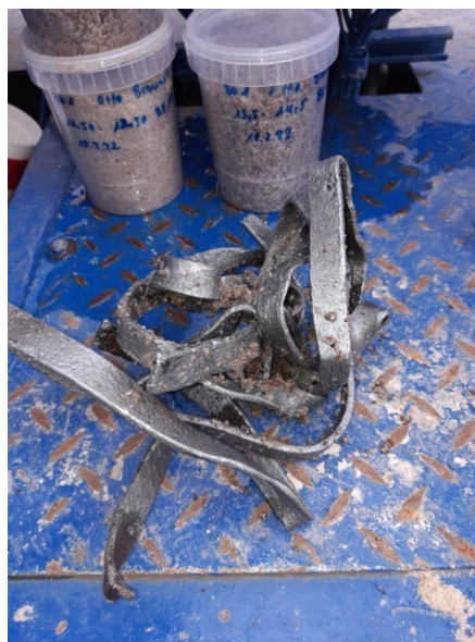
Abbildung 9-1: Stahlbänder aus den Auffüllungen (Standort B-01/22), die sich um das Bohrröhr gewickelt hatten und bis etwa 16 m u. GOK verschleppt wurden.
