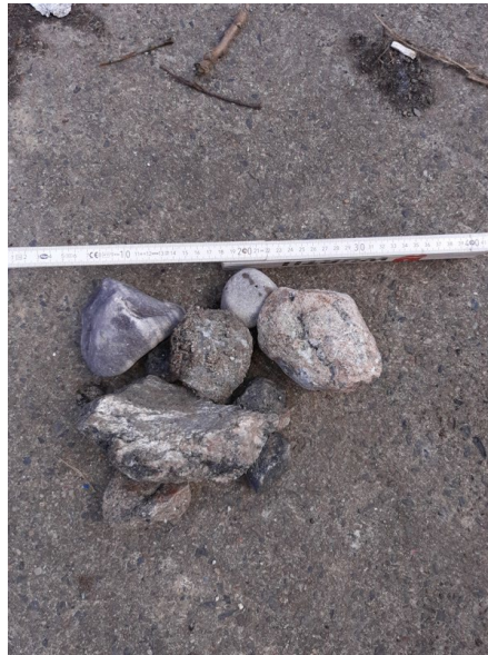
Abbildung 9-2: Erbohrte Gerölle (Standort B-01/22); Tiefe etwa 17 m u. GOK
