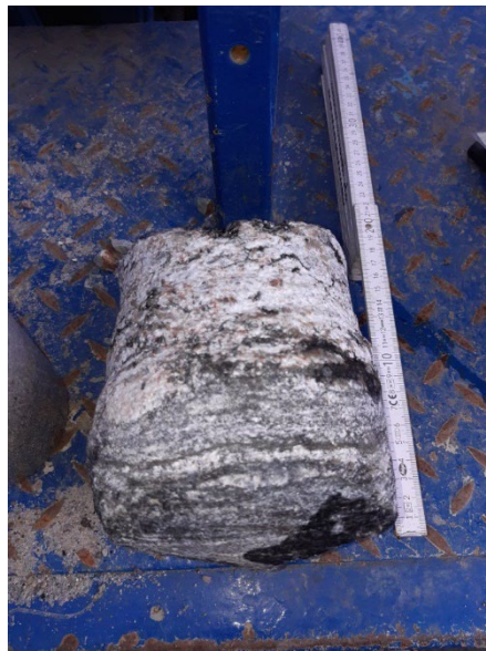
Abbildung 9-3: Durchkernter Stein (Standort B-01/22); Tiefe etwa 44 m u. GOK
